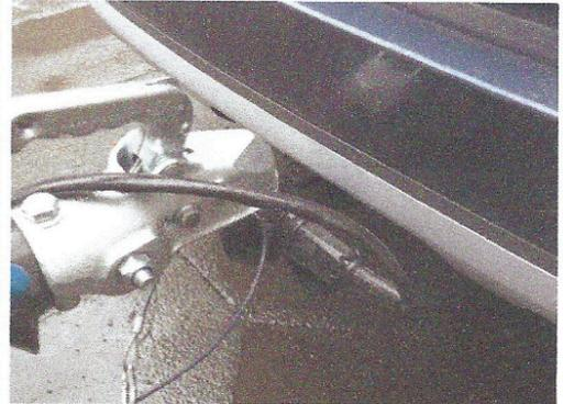
1. Zugfahrzeug bis auf einen Meter an den Anhänger heranfahren
